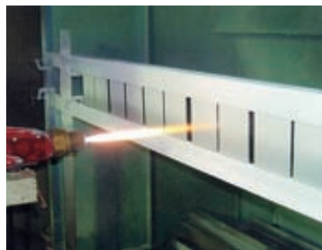
光触媒特性に優れたTiO 2 （アナターゼ型）溶射加工の様子
