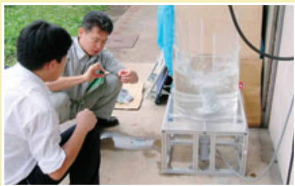
効果的な水流を生み出すために、スクリューと側面のじゃま板の形状設計が開発のポイントとなった。メンテナンスや衛生面を考え、シンプルな内部構造になっている。写真は、岩手大学で行った水流実験の様子（左）とワカメの自動刈り取り機での作業風景（右）
