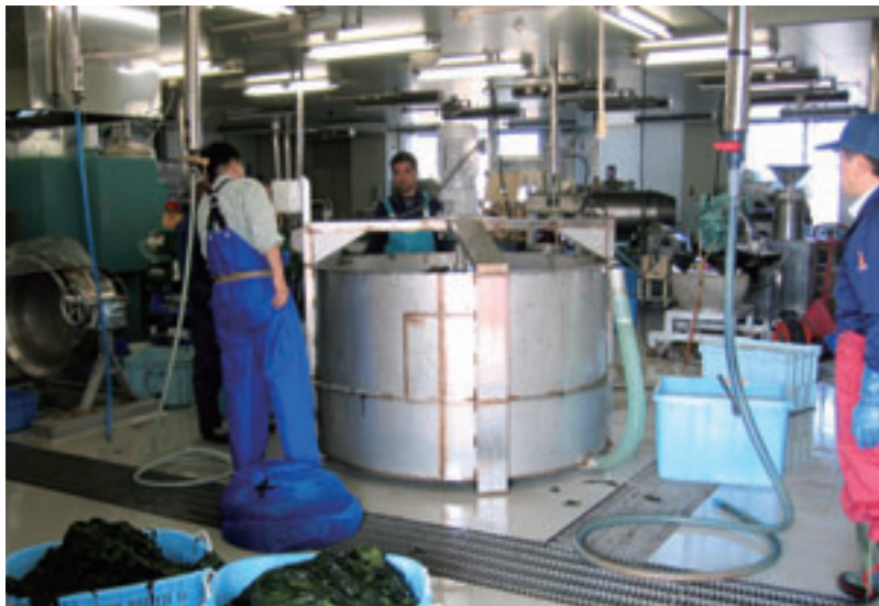
平成18年に試作した直径1.6メートルの塩蔵装置。岩手県水産技術センターでの実験風景
