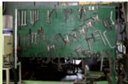
整理整頓された工具類。ボードの各フックには番号がつけられ、さらに工具のかたちも描かれていて、向きが一定で吊り下げられている
