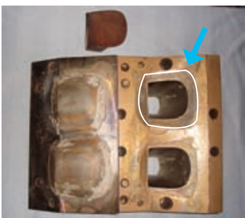
図2 実用化しているハイヒール踵金型
