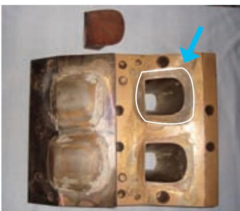
図2 実用化しているハイヒール踵金型
