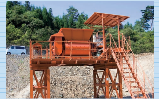
▲木材破碎プラント。同機は東北に2台、全国でも11台しかない。松田重機では、その2台を所有。プラントは分解して現場に移設する
