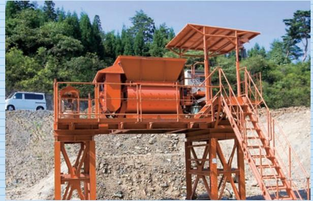
▲木材破砕プラント。同機は東北に2台、全国でも11台しかない。松田重機では、その2台を所有。プラントは分解して現場に移設する
