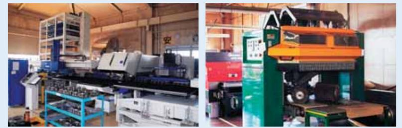
ドイツ製のパンチ・レーザー複合機はじめ立体形状にも対応可能な3Dバリ取り機(デンマーク製)、デジタルで加工スピードを制御するレーザー加工機など、最新の板金加工機が導入された岩手工場内。マシンングセンターやワイヤーカット放電加工機なども設置されているため、金型などの治工具もすべて自社内でまかなう態勢が整っている。
