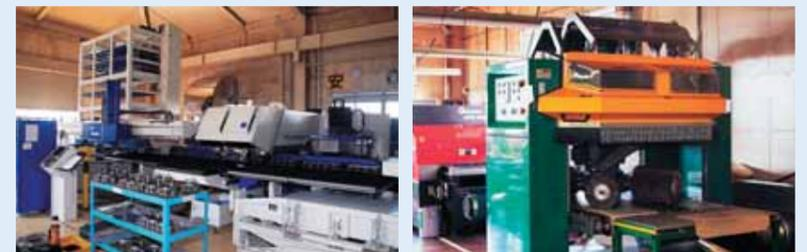
ドイツ製のパンチ・レーザー複合機ははじめ立体形状にも対応可能な3Dバリ取り機(デンマーク製)、デジタルで加工スピードを制御するレーザー加工機など、最新の板金加工機が導入された岩手工場内。マシンングセンターやワイヤーカット放電加工機なども設置されているため、金型などの治工具もすべて自社内でまかなう態勢が整っている。
