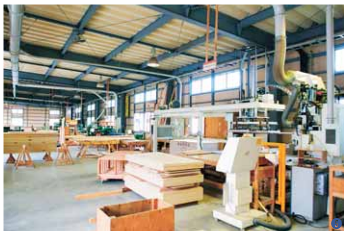
⑤⑥ 水沢工業団地にある第2工場では住宅用パネルを製造。壁面、床面、屋根材までオールインワンの製品を製造する。第1工場のプレカット材や羽柄材も含め、木造住宅の骨組みに関する全ての部材を提供できるのが強みだ。
