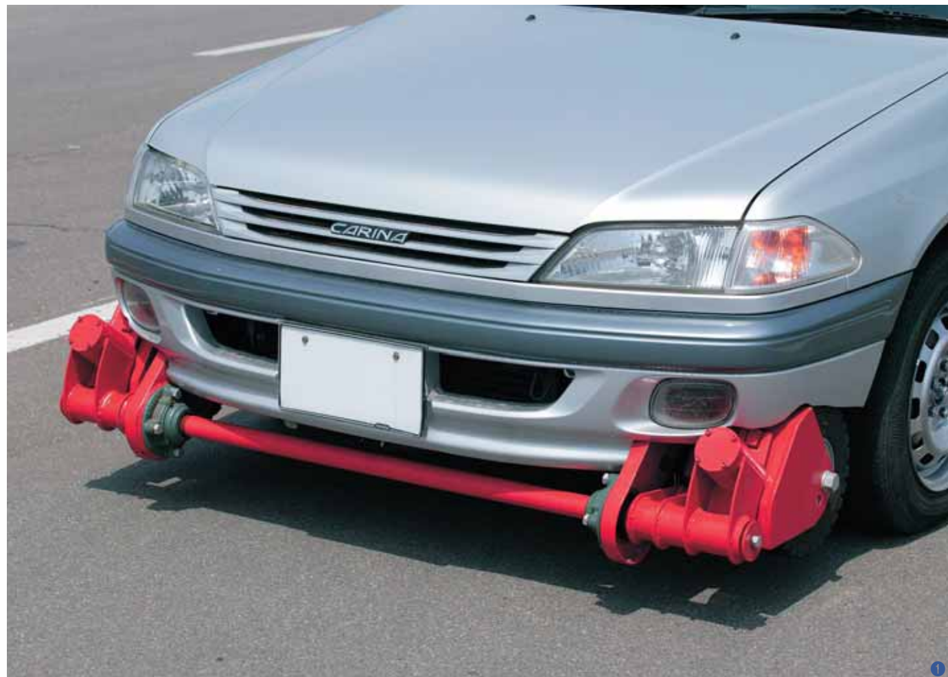
①フロント補助輪は車体の前の部分に設置され、上下動する。車種によってはブレーキの変更や車外機器の移設など必要になるため、改造には10日間から長くて半年程度がかかる場合もあるという。
