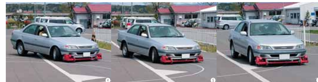
②走行中いつでもスリップの発生・解除ができるので安全を確保しながらの教習が可能だ。対象は前輪駆動乗用車(FF車)。
