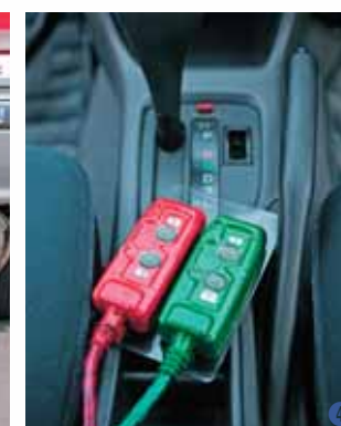
③リア補助輪はタイヤの内側に設置されており、リモコンで角度30度の範囲内で上下動を操作できるようになっている。補助輪タイヤは摩擦や強度を考え、フォークリフトなどに使用されるノンパンクタイヤを採用。
