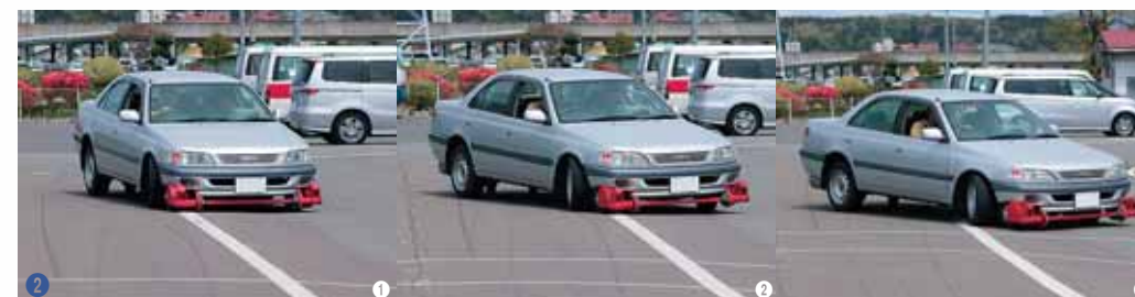
装置は車両前後の内側それぞれに補助輪を備えたスキッド発生装置を設置し、助手席の指導員などが手元のリモコンで操作を行う。走行中フロント補助輪を下げればタイヤが上がってブレーキとハンドルが効かない状態になり、一方カーブでリア補助輪を下げればスキッド(横滑り)が体験できる。
