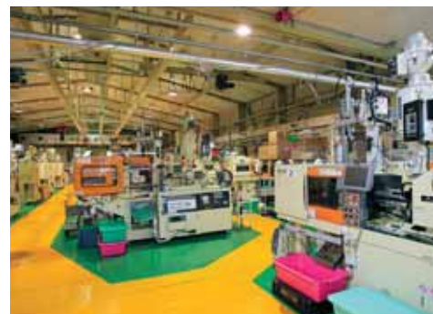
工場は24時間稼働。多様化するニーズに応えるため、当社では射出成形機ほか自動インサート成形ロボットなども設置し、少数精鋭体制で開発と製造にのぞんでいる。
