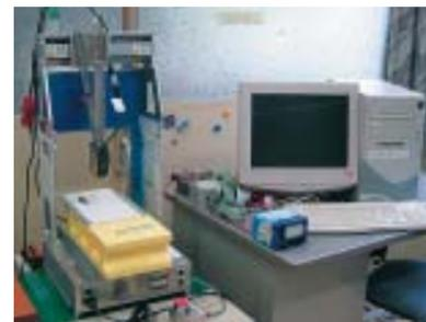
【写真1】 3次元形状計測器
