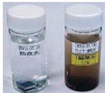
【写真1】防食水(左)とワイヤーカット放電加工機の加工水(右)に浸した炭素鋼
