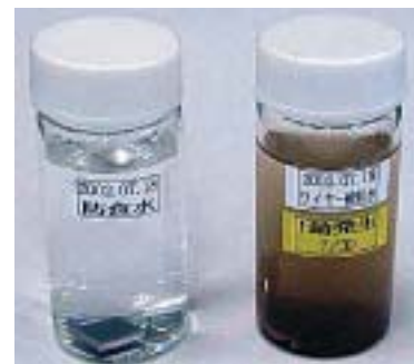
【写真1】防食水(左)とワイヤーカット放電加工機の加工水(右)に浸した炭素鋼
