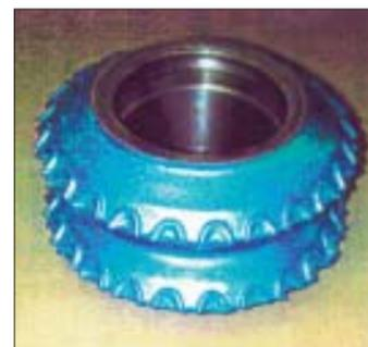
【図2】超硬チップ鑄包みカッタ - コ - ン
