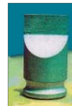
【図4】カッターコーンの製造工程と鑄包みに使用した超硬チップ
