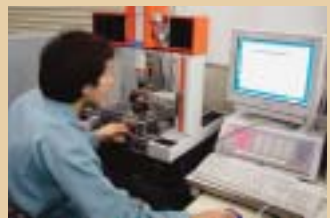
「マイクロボ3000」の頭脳であるパソコンと3次元測定器。測定器で調べたX、Y、Zの原点がパソコンに取り込まれ、各パレットに取り付けられたIDタグで識別する。人為的なミスをなくするための工夫だ。
