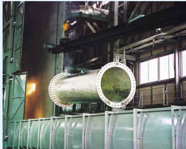
最大めっき可能寸法、長さ13.5m×幅2.0m×高さ2.8m
