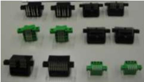
当社が特に力を入れているインサート成形。プレス加工品の精度がインサート成型型に与える影響が大きく、完成品を作り上げるまで様々な困難が立ちはだかりますが、製品が完成し、お客様に満足して頂いた時の喜びは他に替えられません。当社は堅型成形機を利用し、インラインでのインサート成形を行っております。プレス技術によって培われた私たちのインサート成形サービスにより、更なるお客様の満足を得られるべく努力を続けます。
