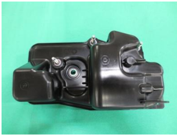
サージタンク
