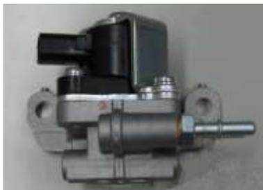
ロータリーEng.のロータ先端部に装着されるアペックスシール部の潤滑のため、微量なEng.オイルを計量し供給するオイルポンプ。ソレノイド駆動のプランジャー式ポンプ。
