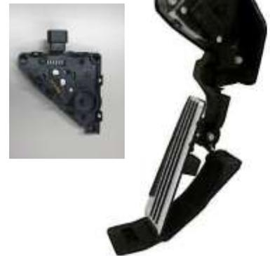
モータ駆動により、アクセルペダルを押し戻す(アクティブ)機能を備えたコントローラー体式ペダルモジュールのコントロールユニット。ECUからの信号を受け、条件に応じペダル操作を重くし踏みすぎを抑制することにより、燃費改善となる。
