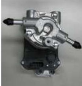
一般的なオイルポンプは、Eng.で駆動されているためアイドルングストップシステムなどでは、Eng.停止時に油圧が確保できなくなるためオイルポンプを電動化(EOP)している。Eng.停止時の油圧確保のほか、低温時の潤滑性確保、複数個所の潤滑可能などの機能を有するため大容量化した大型EOPを開発量産中。現在、低流量、低ノイズタイプの小型バージョンを開発中。
