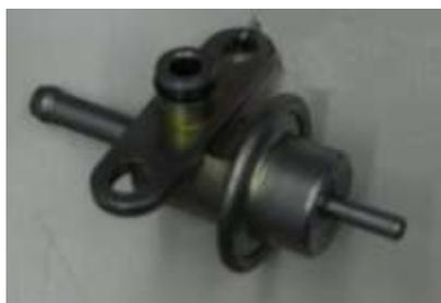
スプリングとダイヤフラムとで構成された調圧弁。電子制御式燃料噴射システムに用いる燃料噴射圧力調整装置。
