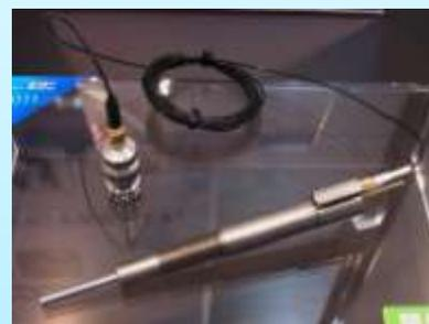
ディーゼルエンジン用の燃焼圧センサ。シリンダ内の燃焼圧をリアルタイムで測りデータをECUに送ることにより、ECU側で最適燃焼状態になるよう制御することが可能になる。
