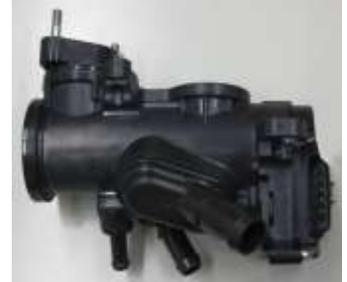
ENG.の冷却系複数流路を本バルブで制御、Eng.ブロック壁温、駆動系の水温を早期上昇させることによりメカニカルフリクションロスが低減、結果として燃費改善につながる。
