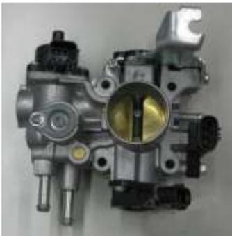
電子制御燃料噴射装置においてスロットル・バルブの位置(ポジション)を検知する部品。
