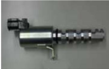
可変バルブタイミング(VVT)システムは、エンジンの運転状況に応じ、バルブの開閉タイミングを変える。エンジン制御ECUは、カム角センサやクランク角センサからの信号を演算し、油圧コントロールバルブ(OCV)の制御を行って、VVTアクチュエータの内部ベーンを連続的に動かし、バルブの開閉タイミングを最適に調節する。
