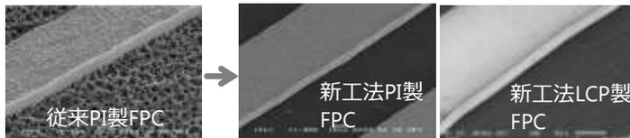
従来の凹凸のアンカー効果と分子間力によって製造されたFCCLから作製したFPCは、銅回路と基板の界面にも凹凸があるため高周波信号の損失が大きいという問題がありました。
